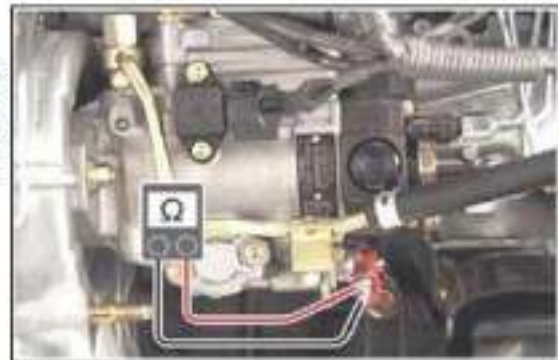
Hình 2.27. Kiểm tra điện trở van TCV.
